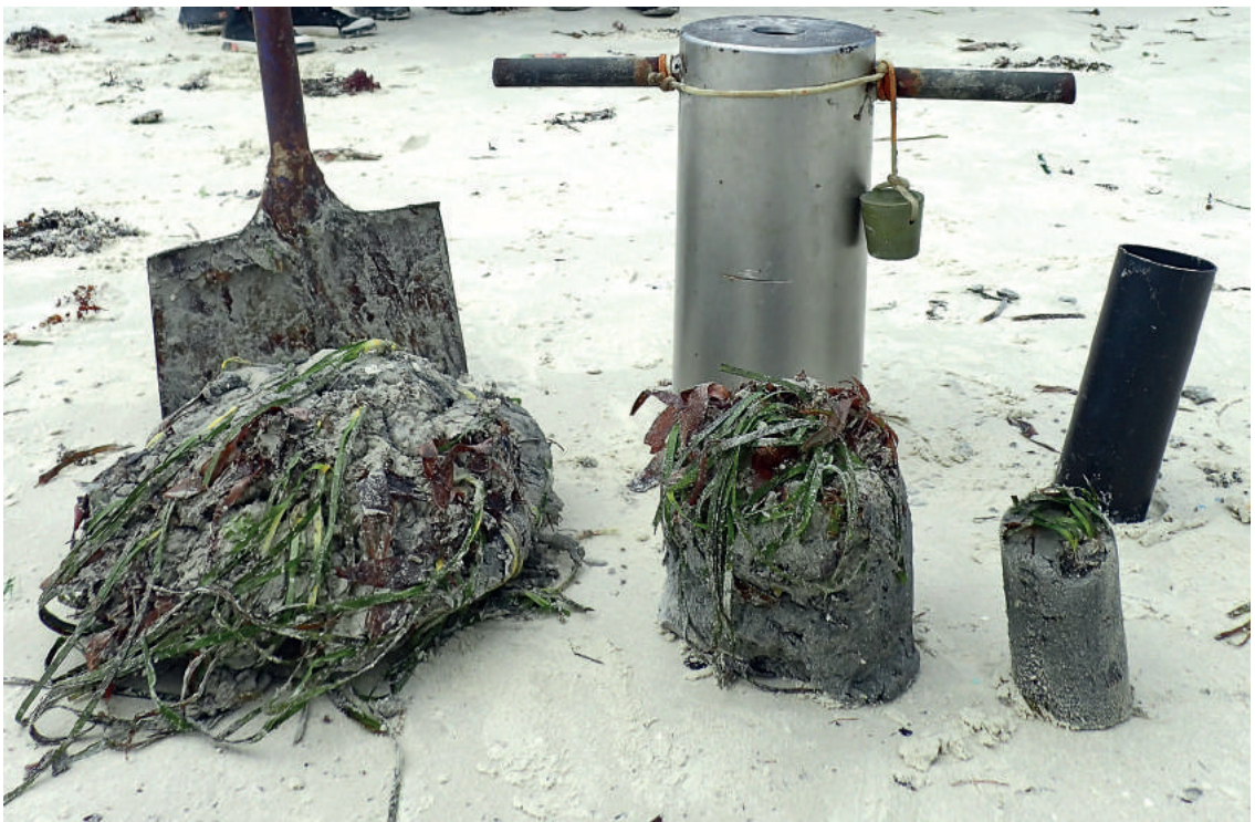
Cadre 12. Démonstration de la méthode « herbiers avec sédiments », montrant du gazon avec une pelle (à gauche) et deux tailles de bouchons avec des carottiers.
