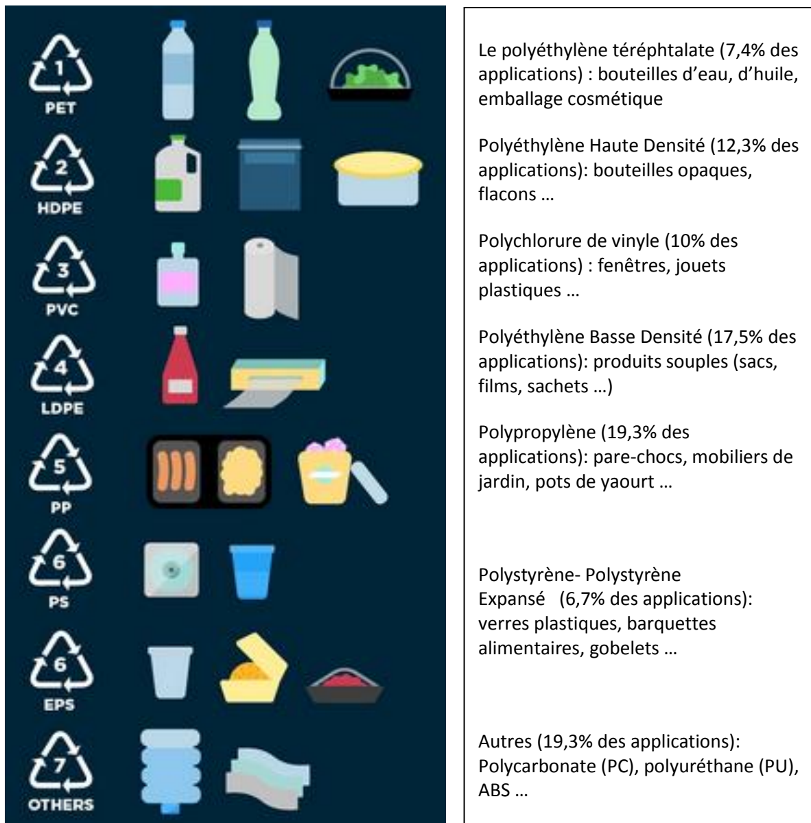
Figure 6 : les principales résines thermoplastiques utilisées et leurs applications industrielles
